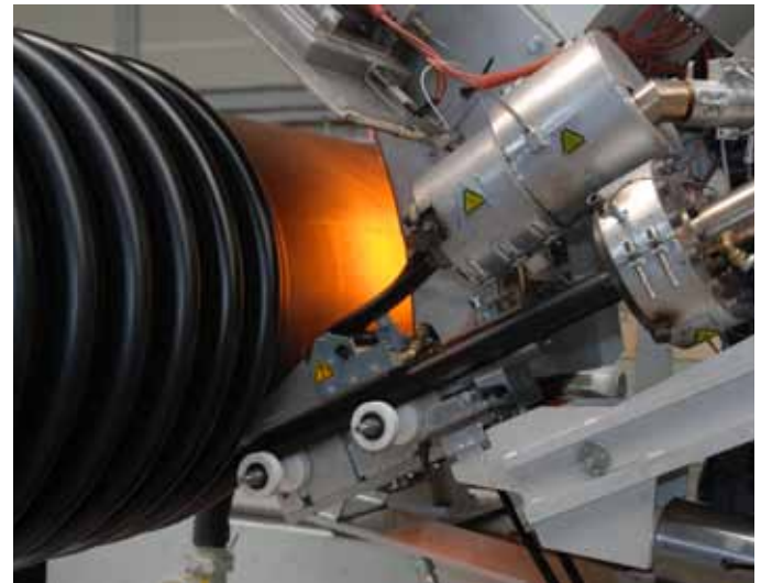
Herstellung von Kunststoff-Großrohren bis 2,4 Meter im Durchmesser für Tiefbau und Sonderanwendungen bei der DRS-Rohrwerke Sachsen GmbH
